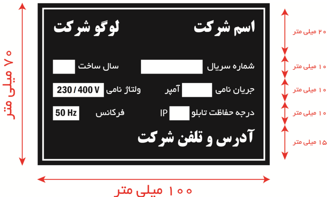
شکل (پ ۵): نمونه پلاک مشخصات تابلو
